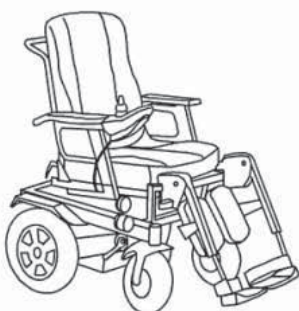
A- صندلی چرخدار مدل الکترونیکی مبله w = 670 \text{ mm} L = 1100 \text{ mm}
