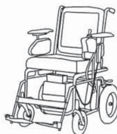
A- صندلی چرخدار مدل الکترونیکی ساده w = 630 \text{ mm} L = 990 \text{ mm}
