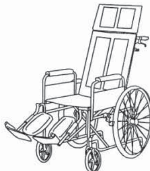
B- صندلی چرخدار مدل تخت خوابشو w = 635 \text{ mm} L = 1300 \text{ mm}
