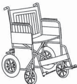
A- صندلی چرخدار مدل همراه w = 535 \text{ mm} L = 790 \text{ mm}
