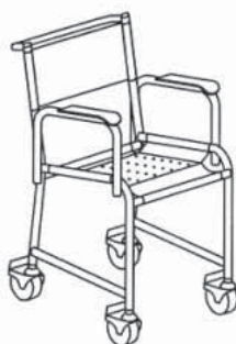
A- صندلی چرخدار ویژه حمام w = 450 \text{ mm} L = 450 \text{ mm}
